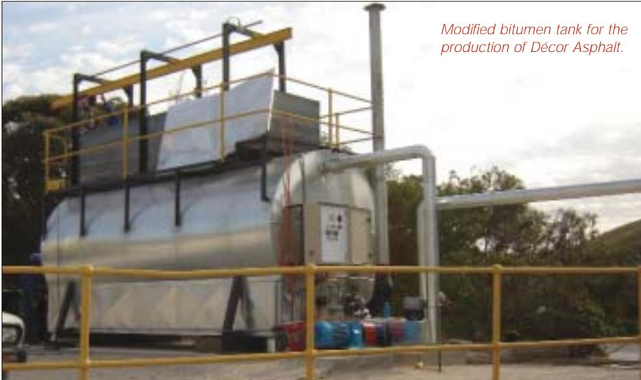
*Modified bitumen tank for the production of Décor Asphalt.*
